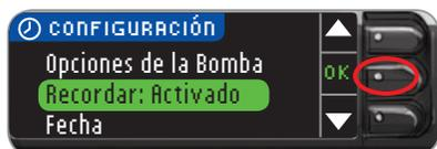
3. Pulse el botón ▼ para resaltar **Recordar: Activado**. Pulse **OK** para desactivar el recordatorio.
