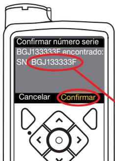
12. Compruebe que el SN (número de serie) en la pantalla de la **bomba** coincide con el SN (número de serie) del **medidor** en la pantalla del **medidor**.
