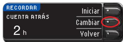
Para cambiar el tiempo de la cuenta atrás del recordatorio, pulse **Cambiar**.
