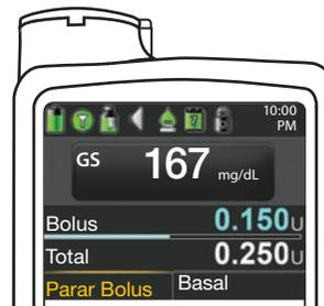
**NOTA:** Compruebe que la cantidad del bolo del medidor coincide con la cantidad total que se muestra en la bomba.
